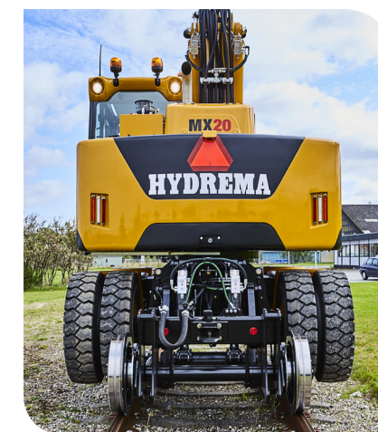
Molempiin Hydrema MX -malleihin on saatavana sekä pyörä- että kiskovarustus. Kapean leveytensä ansiosta MX16 Rail -mallia voidaan käyttää myös kaksiraiteisilla osuuksilla, sillä se ei estä vastaantulevaa liikennettä.
