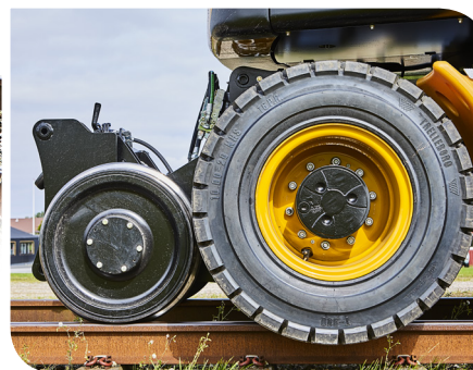
Hydrema testasi MX Rail-koneissa monia eri renkaita. Trelleborg T-900 osoittautui riittävän vakaaksi ja kestäväksi sekä terävällä murskeella että kapeilla raiteilla ajamista varten.
