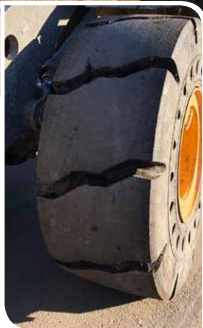
Fire nye specialtilpassede dæk er monteret på en af maskinerne, og resultatet er tydeligt. Hjulslippet forsvandt straks.
